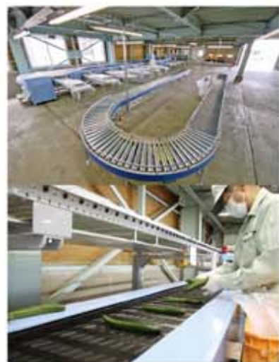
櫛引支所に導入したキュウリ画像選果機。 4月28日から稼働している。
