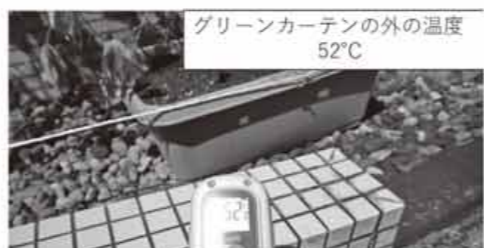
写真3. グリーンカーテンの外のブロック表面温度(52℃)
